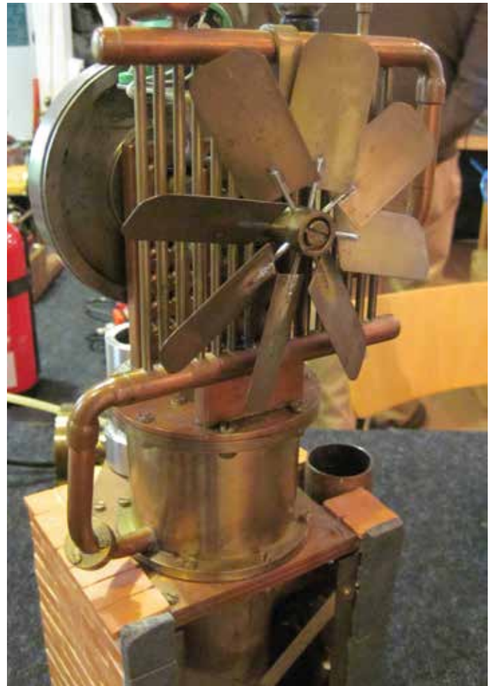
Ein alter Ventilator, der mit einem Stirling-Motor angetrieben wird.
