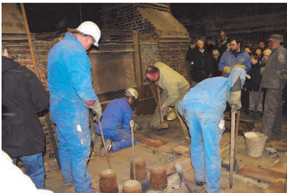
Der Zapfen wird herausgeschlagen
