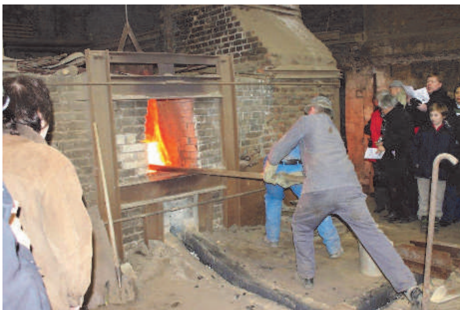
Zinnbarren werden der Glockenspeise beigegeben
