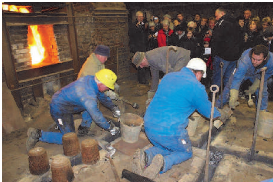
Die Holzkohle wird aus den Kanälen geschaufelt
